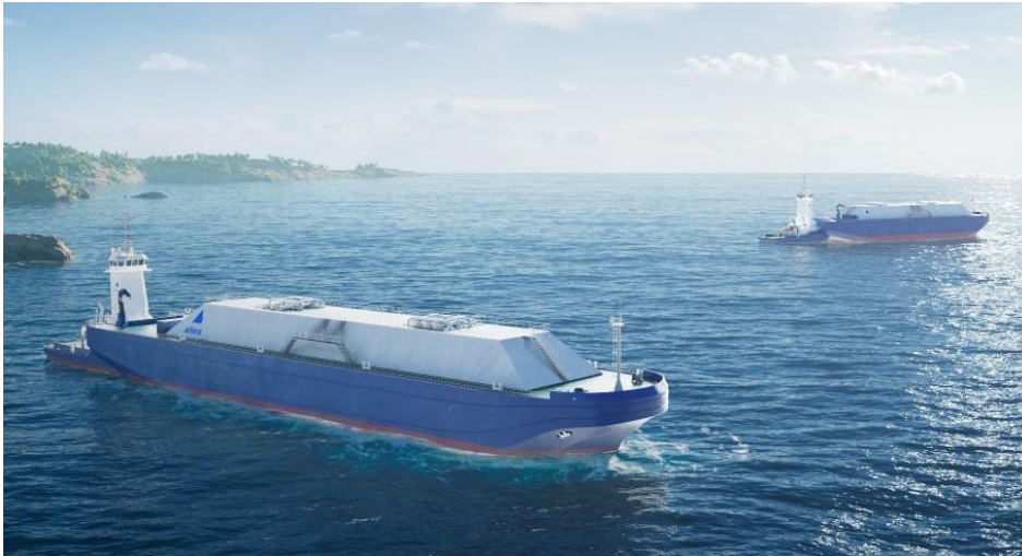
Figur 21 Pråm/pusher-ekipage för transport av LCO 2 (Illustration: Stella Maris CCS)
