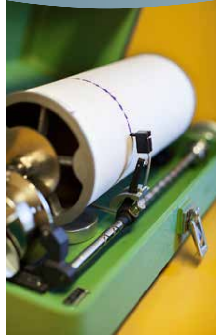
Pegelmätaren är numera backup till den elektroniska mätningen.
